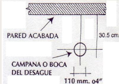
2. Con un lápiz, trace en el piso una línea vertical y una horizontal, de manera que se forme una cruz alineada con la pared, en la que el centro coincida con el de la boca de la campana de aguas negras.
