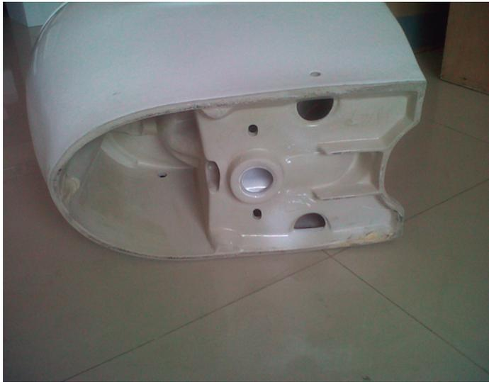
Para evitar los escapes de olores antes de instalar se debe verificar que el sanitario se va a instalar con brida, si no, se deben tapar los agujeros señalados en la foto para evitar los escapes de malos olores por dentro del mismo o que salgan por el tanque.
