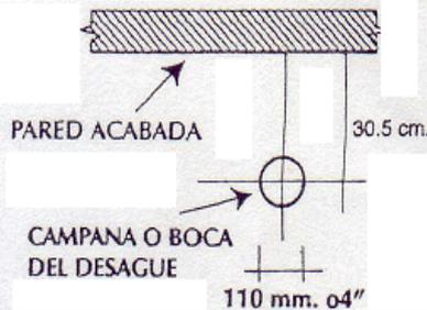
2. Con un lápiz, trace en el piso una línea vertical y una horizontal, de manera que se forme una cruz alineada con la pared, en la que el centro coincida con el de la boca de la campana de aguas negras.
